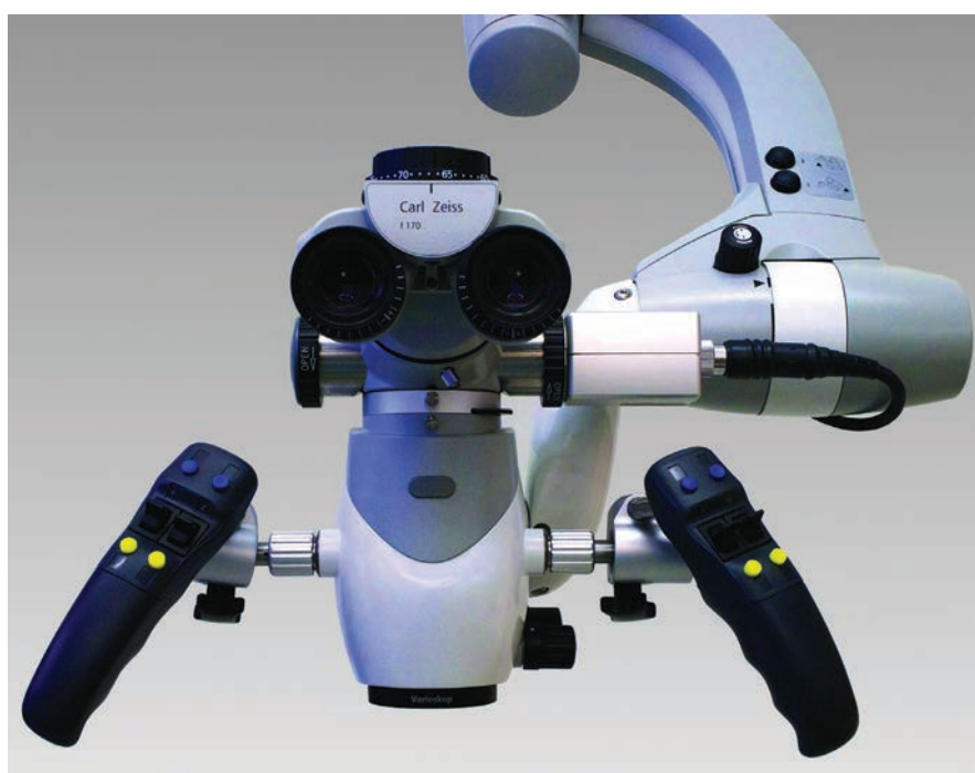
• شکل ۱۰۵ میکروسکوپ درجه یک با زوم الکتریکی، فوکوس دقیق و عملکردهای قفل مغناطیسی، همراه با دوربین ویدیویی HD سه‌تراشه‌ای (TRIO 610) متصل به پورت مستندسازی سمت راست (ZEISS PROergo؛ کلینیک اندودانتیکس دندانپزشکی پِن، واحد جراحی).
