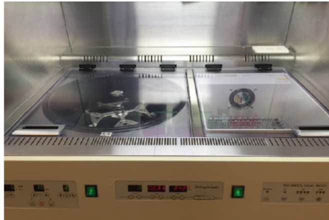
شکل ۱- داخل ایستگاه چندگانه P&C. سمت چپ شامل سانتریفیوژ با ظرفیت ۴۰۰cc و سمت راست شامل یونیت شیکر گرم شده است.
