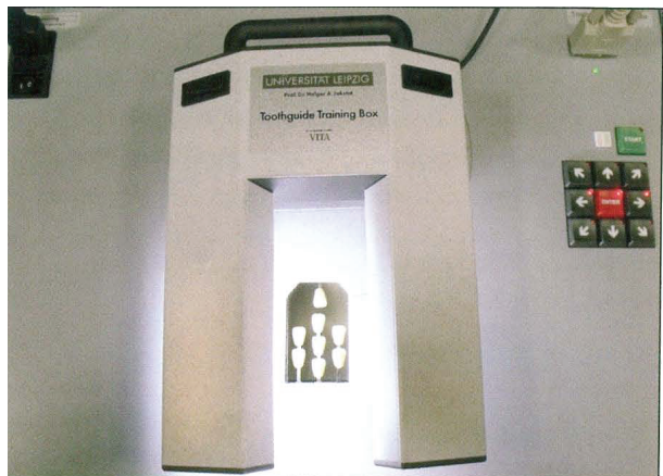
شکل ۳-۱: Toothguide Training Box همراه با ناحیه ای که توسط نور اصلاح شده روشن شده است.
